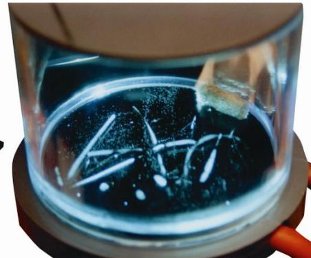
Abb. 2  $\alpha$ -Strahlung, ausgehend von einem Thorium-Glühstrumpf bzw. aus Umweltstrahlung
