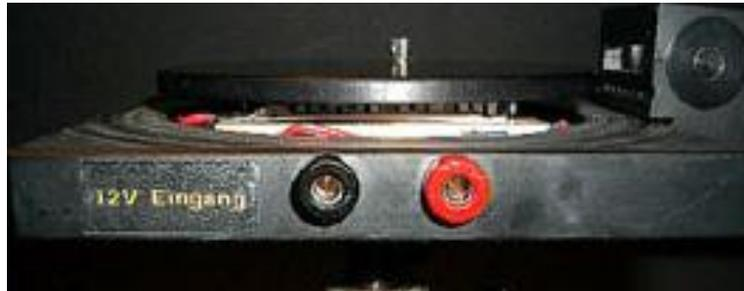
Abb. 5 Anschlüsse für die Versorgungsspannung von 12-15V / 8A
