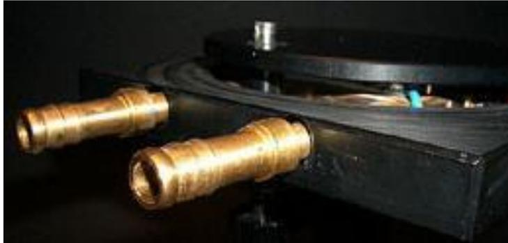
Abb. 7 Anschlüsse für den Kühlwasserkreislauf
